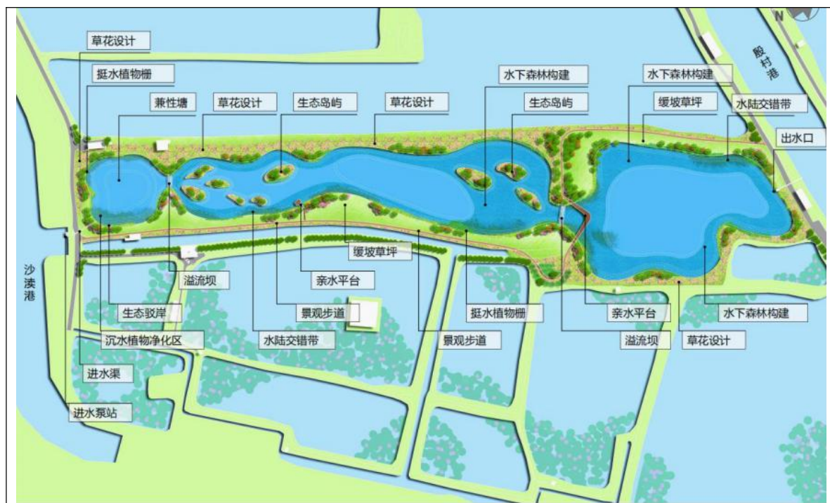
图 2.5-4 农业面源氮磷生态拦截净化工程
